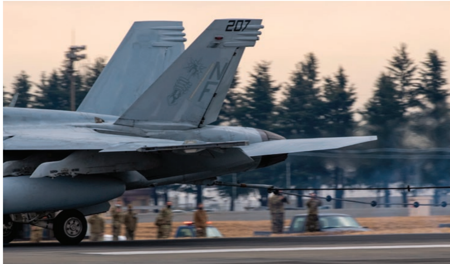
横田基地滑走路で2月4日、航空機拘束制動ケーブルで拘束された第27戦闘攻撃飛行隊(VFA-27)、ロイヤルメイス所属の米海軍F/A-18Eスーパー・ホーネット。これは同日、横田基地で行われた飛行場BAK-12バリア(航空機拘束制動装置)の認証試験の一部。写真：ヤスオ・オサカベ(第374空輸航空団広報部)
