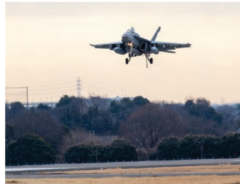
横田基地滑走路で2月4日、航空機拘束制動ケーブルにアレスティング・フックかけるため、フックを伸ばして着陸態勢に入る第27戦闘攻撃飛行隊(VFA-27)、ロイヤルメイス所属の米海軍F/A-18Eスーパー・ホーネット。写真：ヤスオ・オサカベ(第374空輸航空団広報部)
